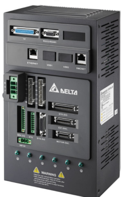
Контроллер робота с интегрированным сервоприводом
